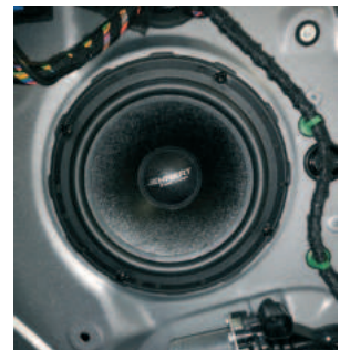
Tieftöner in werkseitigen Einbauorten installiert
