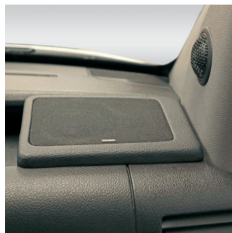
Mitteltön-Modul Armaturenbrett - Bezug Kunstleder, Struktur und Farbe dem Armaturenbrett angepasst
