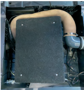
Subwoofer »17005« verbaut unter dem Beifahrersitz
