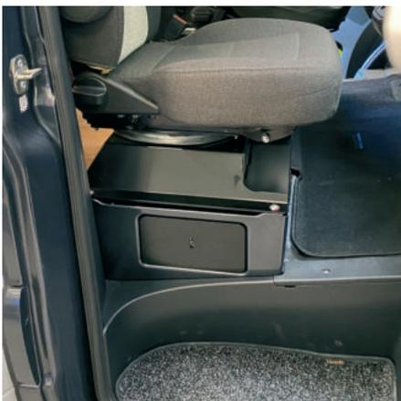
*Safe'n'Sub im Sprinter unter dem Beifahrersitz montiert*
