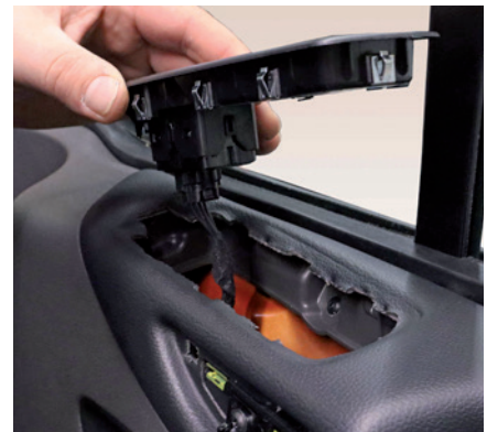
3.7. Schalter für elektrischen Fensterheber und Einstiegsleuchte abstecken.
