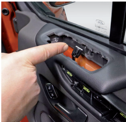
3.7. Schalter für elektrischen Fensterheber und Einstiegsleuchte abstecken.
