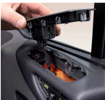
3.7. Schalter für elektrischen Fensterheber und Einstiegsleuchte abstecken.
