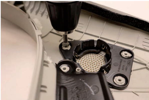
4.4. Werkseitiges Hochton-Modul auf der A-Säulenrückseite entfernen (3x Kunststoffnieten aufbohren).
