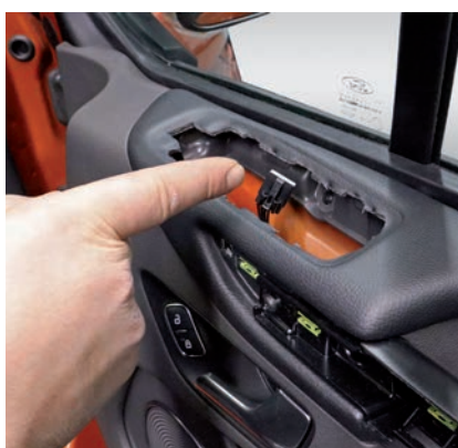
3.7. Schalter für elektrischen Fensterheber und Einstiegsleuchte abstecken.
