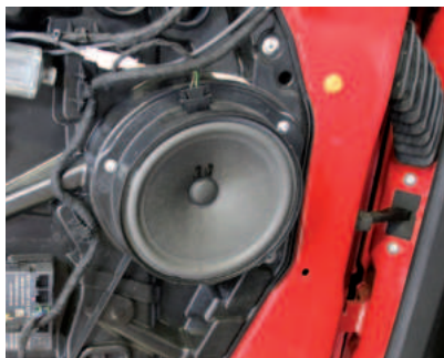
werkseitiger Tieftöner installiert
