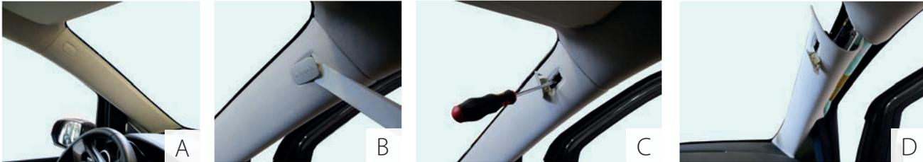
Die A-Säule auf beiden Seiten entfernen, um die Frontgitter demontieren zu können.
