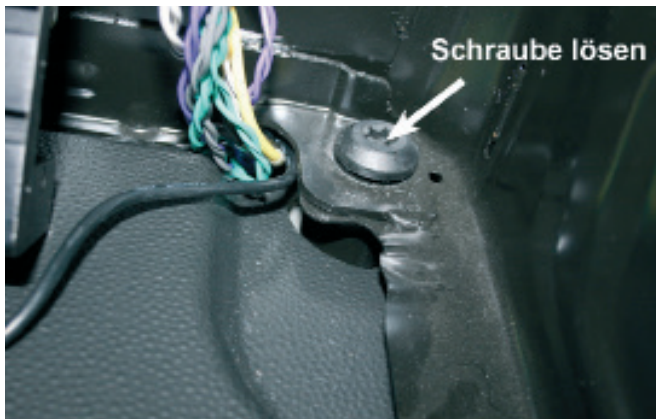
9.1. ISO-Kabel unter der Sitzkonsole durchführen.
