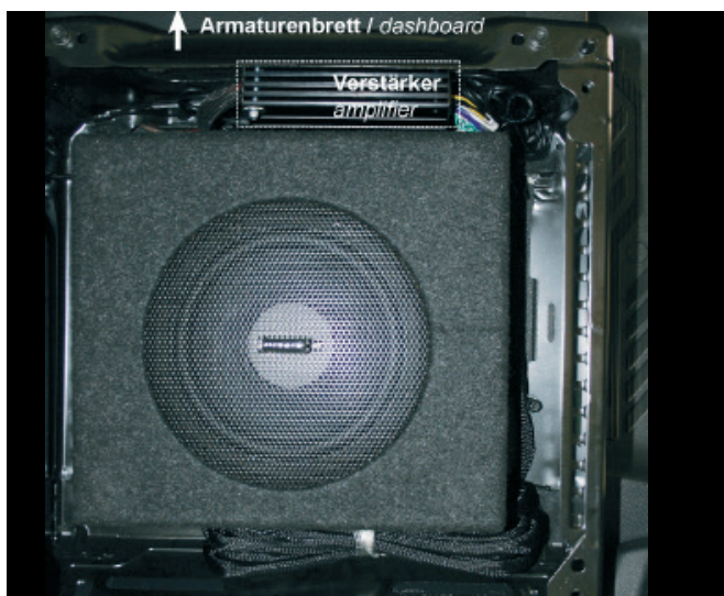
9.3. Die Montagewinkel müssen in die Sitzkonsole an den Montageort (Punkt 9.4.) bevor der Subwoofer eingesetzt wird (ohne Verschraubung).
