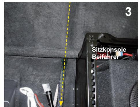
7.5. Teppichboden anheben und Kabel entsprechend zum Beifahrersitz führen. Durch Sitzkonsole führen (falls Boden bereits verlegt).
