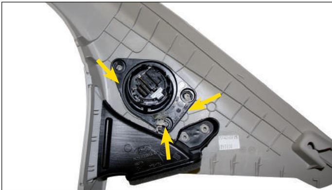
4.4. Werkseitiges Hochtton-Modul auf der A-Säulenseite entfernen (3x Kunststoffnieten aufbohren).
