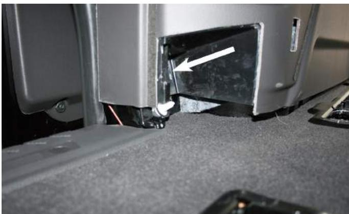
10.4. Clip unter dem Ablagefach aushebeln.
