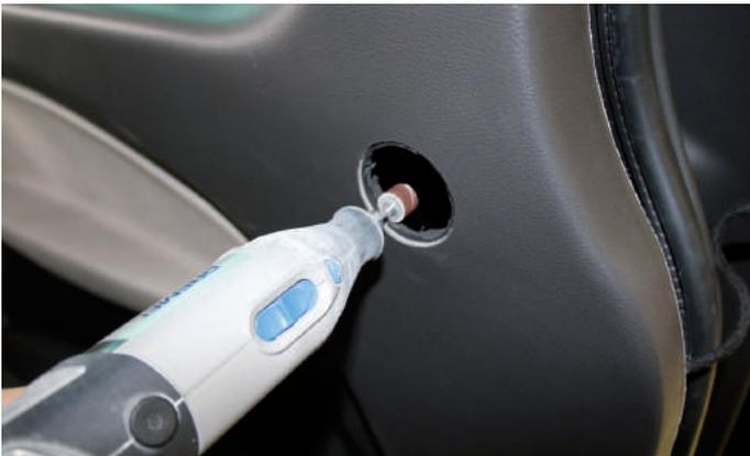
11.3. Hochtönerausschnitt mit einem Dremel an das JEHNERT-Hochtönergehäuse anpassen (Ø ca. 48mm).
