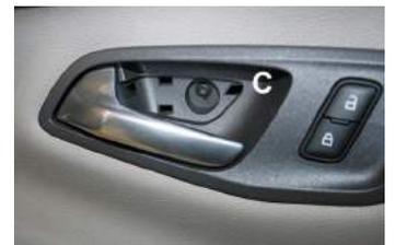
2.2. Rückspiegeleinstell-Schalter (B) (Fahrerseite) aus der Verankerung abdrücken und Kabelanschlüsse abstecken. Kreuzkopfschraube hinter dem Entriegelungshebel (C) herausdrehen.
