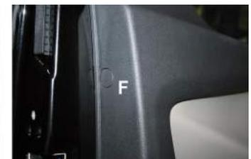
2.4. Blenden (E) + (F) abhebeln und darunterliegende Schrauben entfernen.
