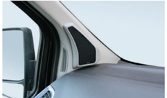
5.3. A-Säule wieder montieren. Abdeckgitter in das Modul einsetzen und an den Kanten fest drücken (nicht in der Mitte). **Wichtig! Das Gitter MUSS unter Beachtung der Kopfaufschlagsradien ringsum plan auf dem Modul aufliegen (Ggfs. ist kräftiges festdrücken erforderlich).**
