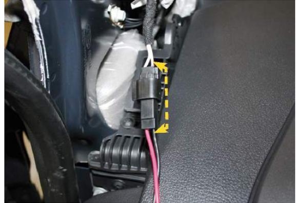
5.2. Frequenzweichen-Eingang mit werkseitigem Hochtönerkabel adaptieren, Stecker mit Filzstück 5x12cm ummanteln. Plug & play Hochtöner Anschluss verbinden (Arretierung Original Stecker in Einkerbung am Adapterstecker)
