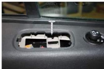
2.1. Fensterscheibe komplett herunterlassen. Schaltereinheit für Fensterheber (A) vorsichtig ausklipsen. Darunterliegende Schraube herausdrehen.
