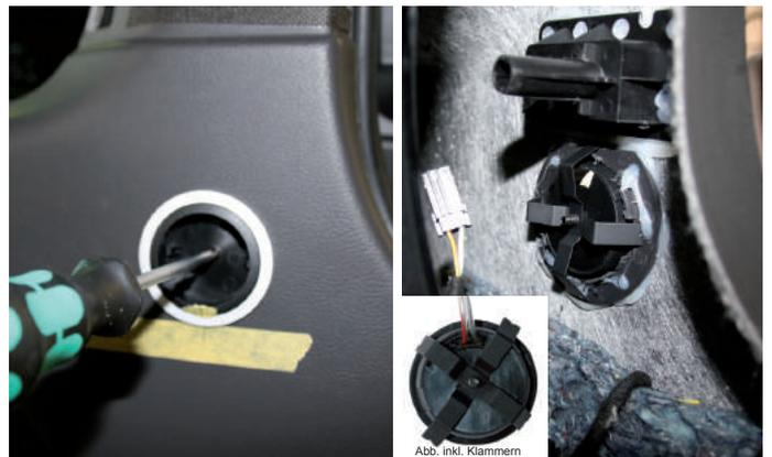
11.4. Montagehalter mit Zierring einsetzen und das Gehäuse mit jeweils zwei Montageklammern auf der Rückseite kreuzförmig mittels Schraube fixieren.
