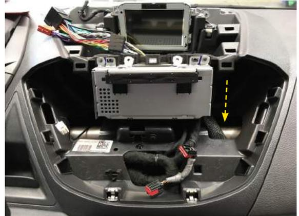
7.2. Demontierte Radiomaske, Ford spezifisches Anschlusskabel seitlich rechts an der Metallrundstrebe (siehe Bild) nach unten führen.
