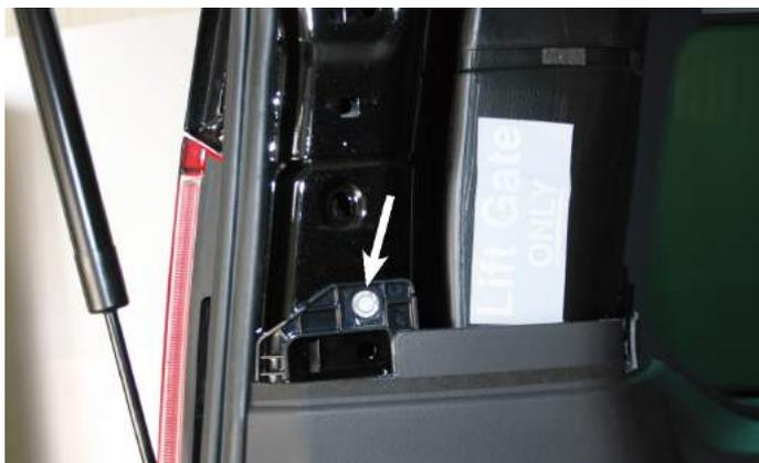
10.5. Schraube oben (D-Säule, Fahrer- und Beifahrerseite)
