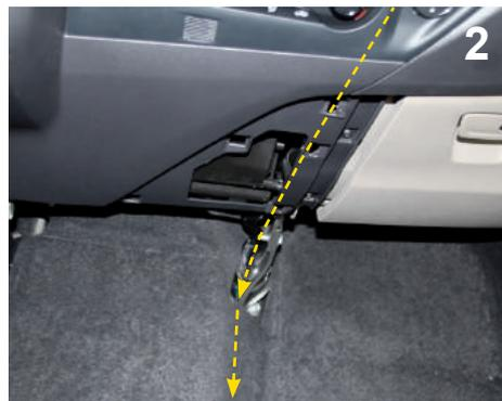
7.4. Anschlusskabel hinter der Verkleidung entsprechend Pfeilmarkierung, hinter der Mittelkonsole durchführen. Durch geöffnetes Handschuhfach abgreifen und unter den Teppichboden führen.
