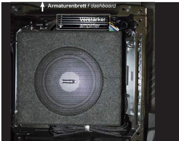
9.3. Die Montagewinkel müssen in die Sitzkonsole an den Montageort (Punkt 9.4.) bevor der Subwoofer eingesetzt wird (ohne Verschraubung).
