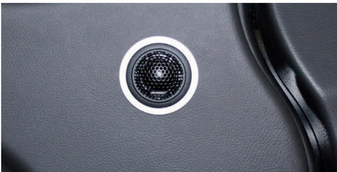
11.5. JEHNERT Hochtöner einsetzen und anschließen.
