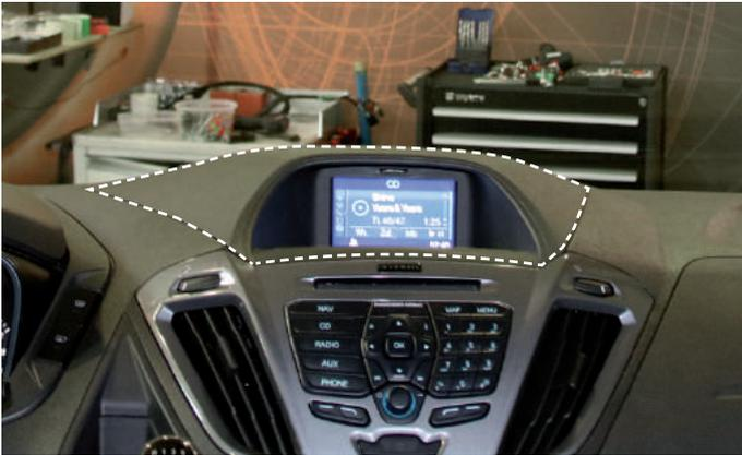
7.1. Abdeckblende des Monitors demontieren (ausclipsen, kann einfach ausgehebelt werden). Darunterliegende Schraubbefestigungen lösen, Radiomaske ausclipsen und Radio entfernen.
