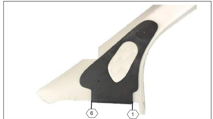
4.5. Montageschablone an „Steg 1,“ anlegen (=bündig mit Steg 6) Anzeichnen des Lautsprecherausschnitts sowie markieren der Bohrlöcher. Mit einer Stichsäge (Feinschneider) Lautsprecherausschnitt ausschneiden. Schraublöcher auf 2mm vorbohren.
