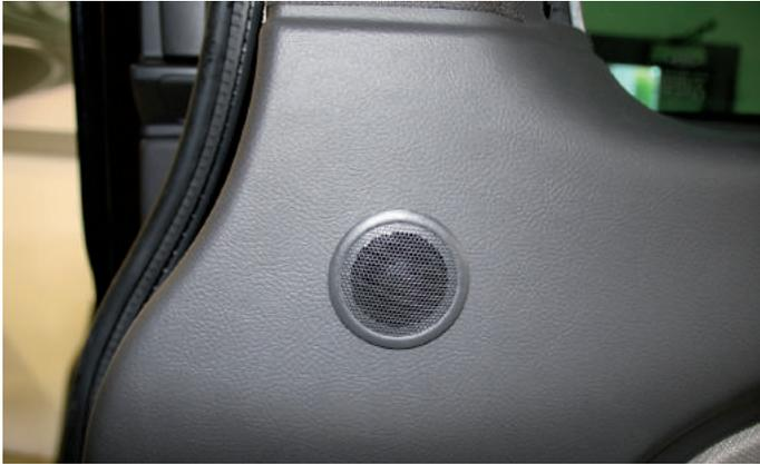
11.1. Werkseitigen Lautsprecher unterhalb der C-Säule demontieren.
