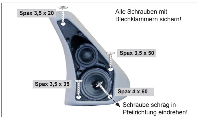
4.7. Mitteltonmodul mit den mitgelieferten Spax-Schrauben montieren. Zur besseren Fixierung des Moduls die untere Spax-Schraube 4x60 leicht **schräg** eindrehen (in Pfeilrichtung, siehe Abb.). Schrauben jeweils mit mitgelieferten Blechmuttern sichern.
