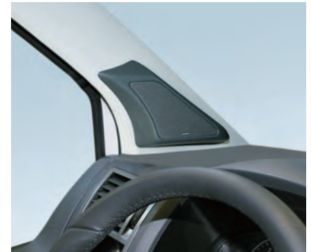
Mittelhochton-Modul in der A-Säule
