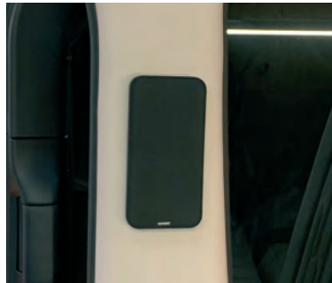
Mittelhochton-Modul in der C-Säule
