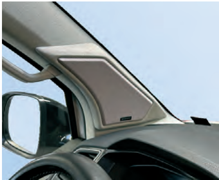
Mittelhochton-Modul in der A-Säule
