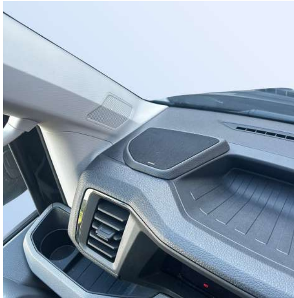
Mittelton-Modul Armaturenbrett - Bezug Kunstleder, Struktur und Farbe dem Armaturenbrett angepasst
