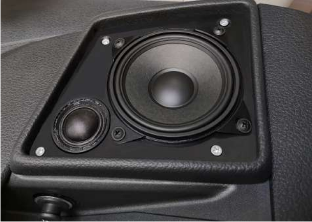
Mittelhochton-Modul (ohne Abdeckung)
