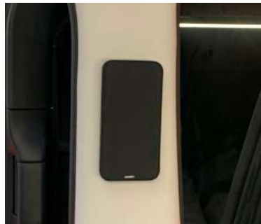
Mittelhochton-Modul in der C-Säule
