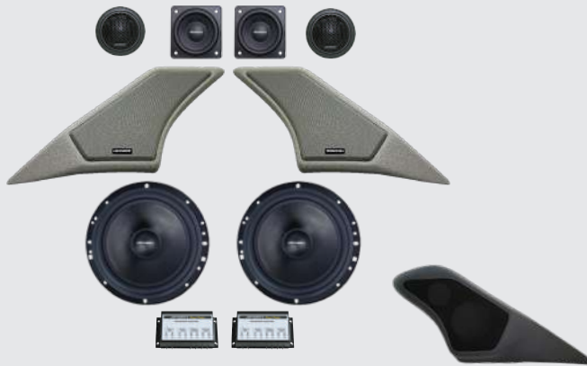
T6.1 3-Wege Frontsystem inkl. 165 mm Tieftöner für Fahrzeugtüren
