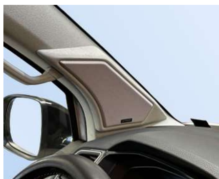
Mittelhochton-Modul in der A-Säule
