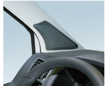
Mittelhochton-Modul in der A-Säule
