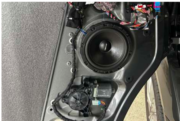
Tieftöner in werkseitigen Einbauorten installiert
