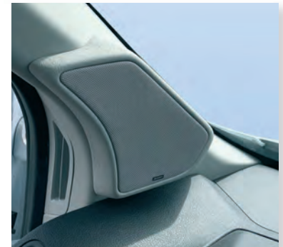
Mittelhochton-Modul in der A-Säule
