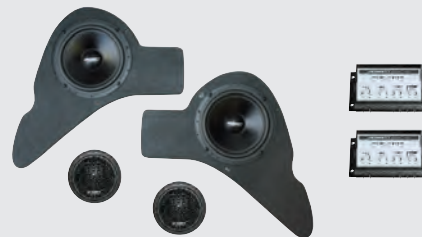
3-Wege Frontsystem inkl. 165 mm Tieftöner für Fahrzeurtüren
