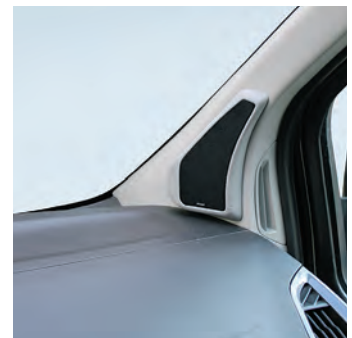
Mittelhochton-Modul in der A-Säule
