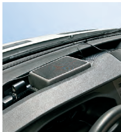
Mittelhochton-Modul auf dem Armaturenbrett
