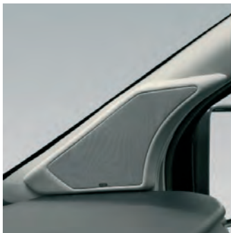
Mittelhochton-Modul in der A-Säule
